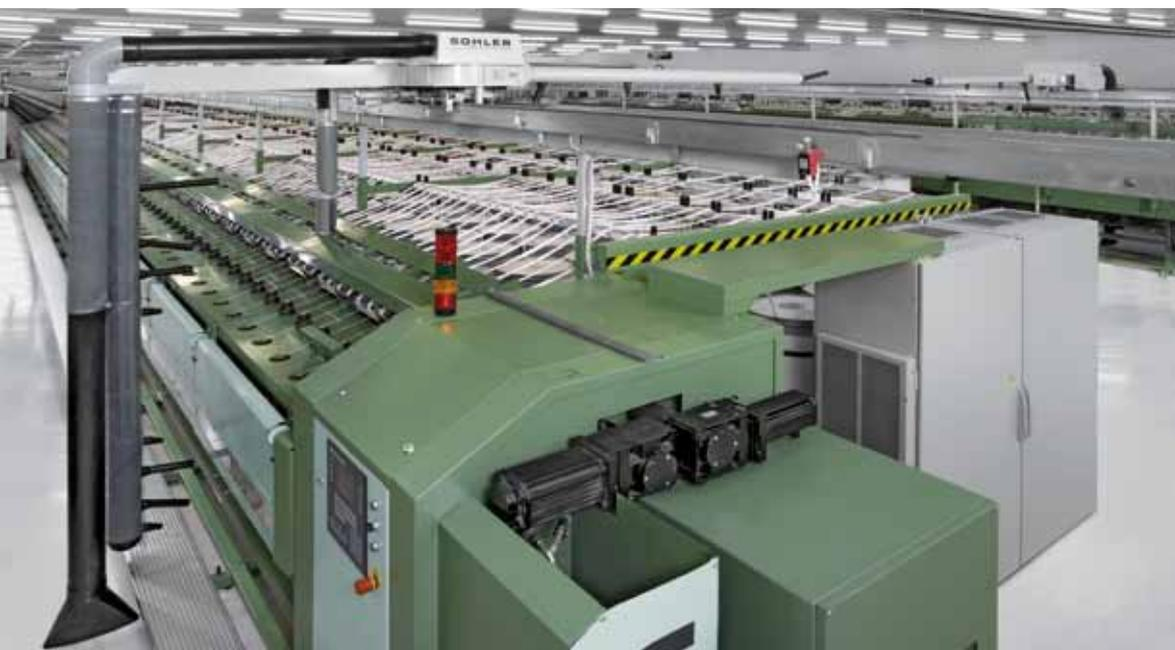
I moderni pulitori viaggianti installati sui banchi a fusi garantiscono un continuo grado di pulizia tramite un soffiaggio ed un'aspirazione mirata del gruppo di stiro, della zona delle alette e del pavimento, creando così delle condizioni ottimali per un stoppino costante.
